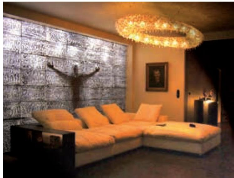
Dans la même veine, le « I Light », conçu par Italcementi Group, permet, lui, de créer des ambiances lumineuses particulières. Ces panneaux de béton, opaques le jour, s'illuminent la nuit grâce à leurs 20 % de surface transparente. Idéal pour cloisonner son intérieur avec design et luminosité !
