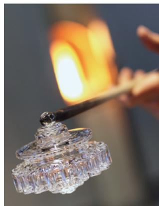
◀ La boule ROTOR avant dépose dans le four de recuisson
